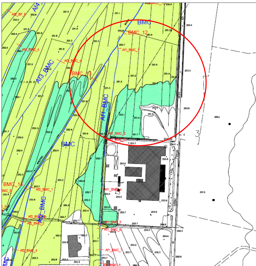
Fig. 4 – Estratto della tavola e7 con le aree allagate allo stato nell'intorno dell'area AT 4.7 (è evidenziata la zona di interesse)
